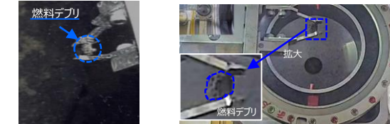
燃料デブリを先端治具で把持した状況
