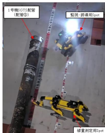
Spotによる配管線量測定イメージ
