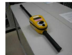
線量計(テレテクタ) 型式: 6112D/H メーカー: オートメス 測定レンジ: 0.01mSv/h-9999mSv/h
