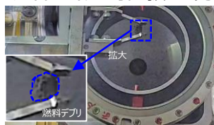
把持した燃料デブリを運搬用ボックスに回収する様子
