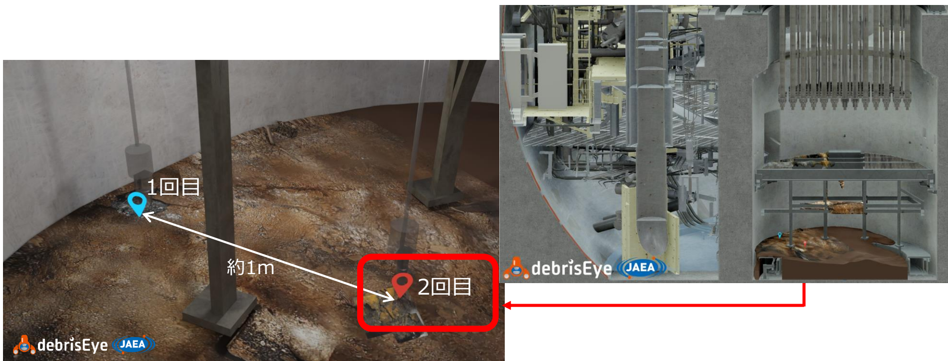
図 2号機ペデスタル内床面 燃料デブリサンプルの採取位置
