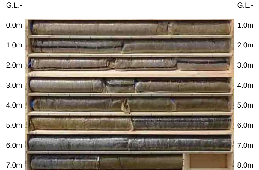
No.25-3-4 ボーリングコア
