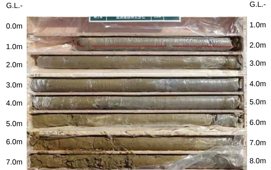
No.24-3-2 ボーリングコア
