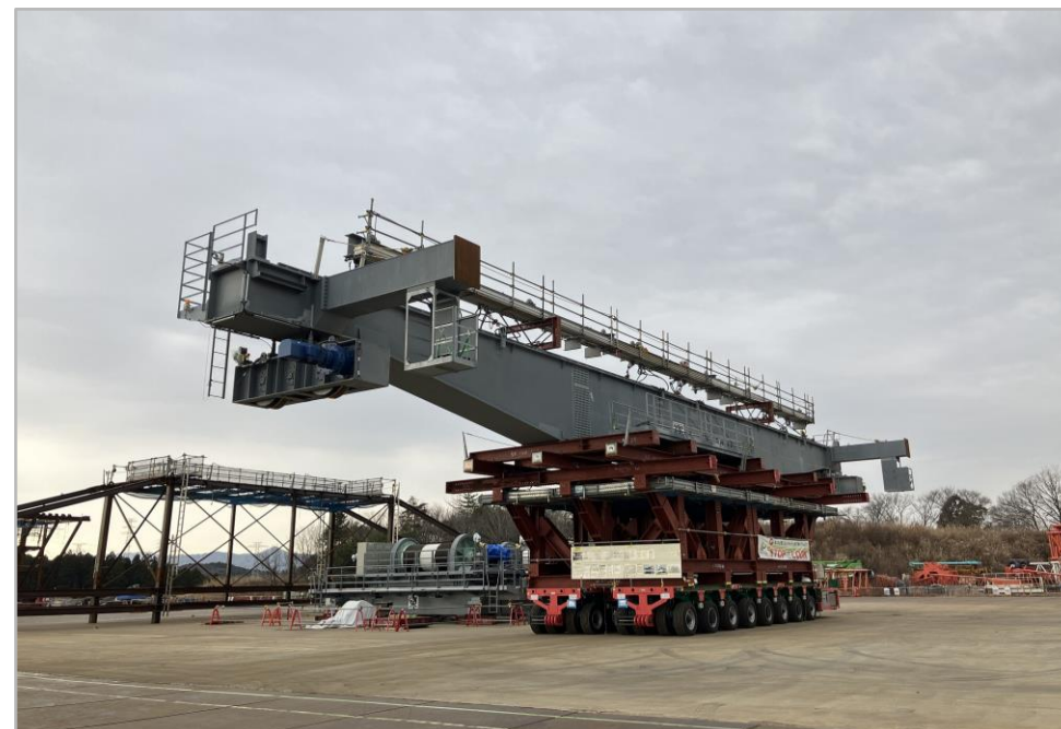
ガレキ撤去用天井クレーン スーパーキャリア積載時 (撮影：2026年1月19日)
