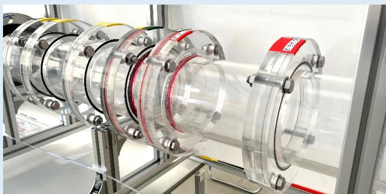
インストール配管 模擬体(左：アクリル製、右：3Dプリンタ製)
