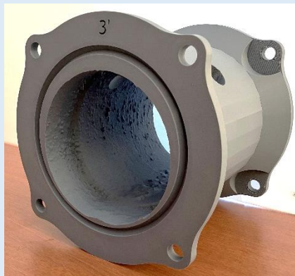
インストール配管 模擬体(左：アクリル製、右：3Dプリンタ製)
