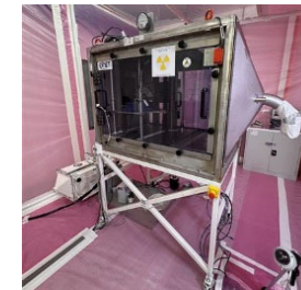
図2 CEAからSONET施設に移設・調整後のディスクカッター切削試験設備
