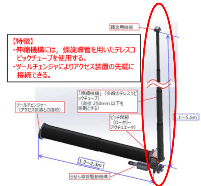
(c) 下部アクセス(RPV)調査装置
