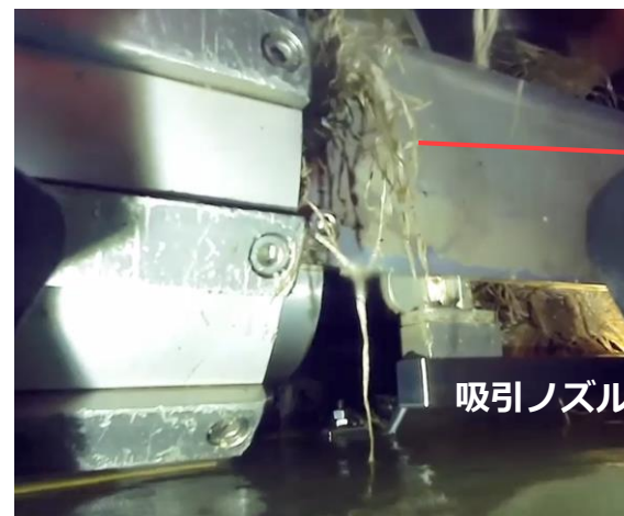
ゼオライト土嚢袋の破片の付着状況 (2026年3月6日撮影)
