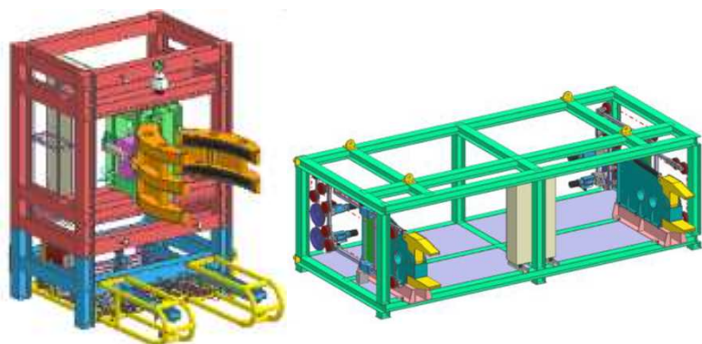
外周鉄骨切断装置（柱・梁）
