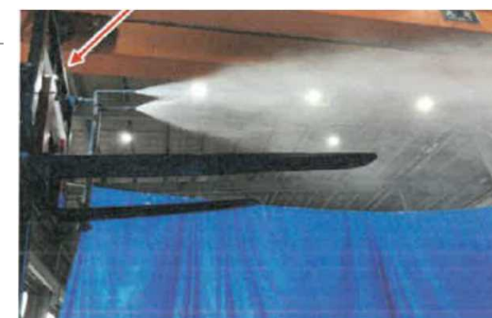
試験噴霧状況
