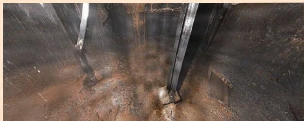
2号機原子炉格納容器内部調査におけるベデスタル底部の様子(2018年1月)(一部加工)/
