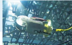
●1号機:原子炉格納容器地下1階を自走式ロボットにより調査(3月)
