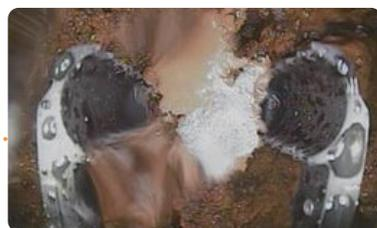
2019年2月2号機にてロボットが燃料デブリと思われる堆積物の持ち上げに成功
