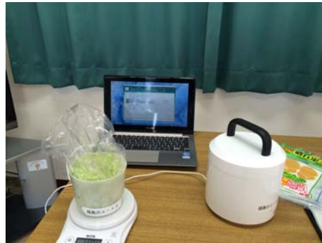
食品測定機 ポリマスター社製 PM1406 15～30 分程で基準値以上以下を判定します。
