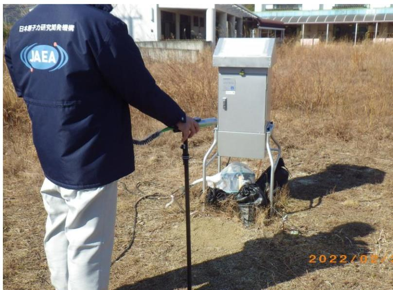
図 2-6 空間線量率の測定作業状況
