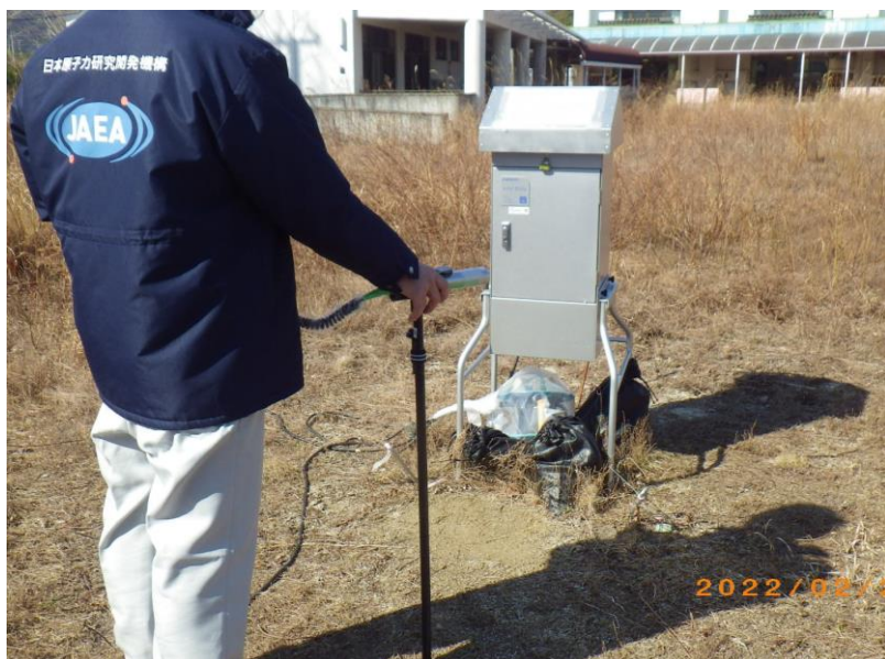
図 2-6 空間線量率の測定作業状況
