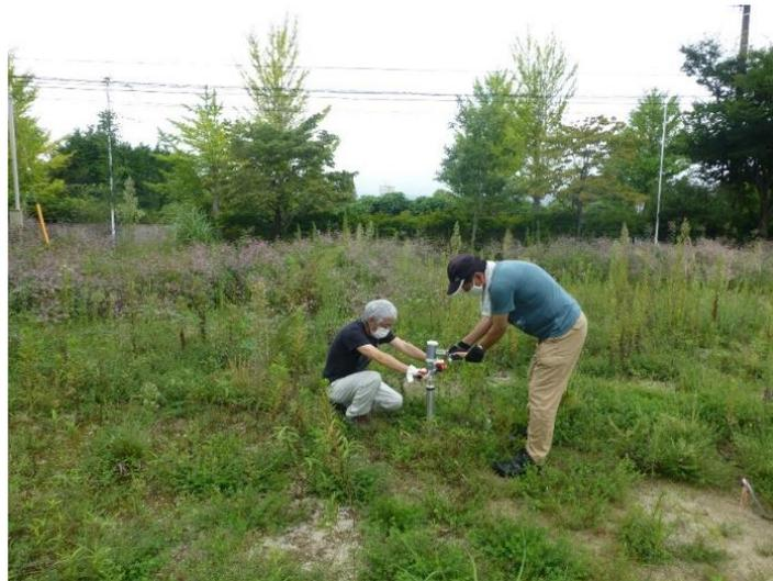
図 3-2 コアサンプラー用いた土壌試料採取風景
