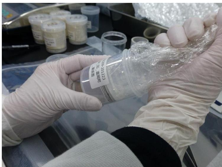
図 2-7 採取試料の放射能測定容器への封入作業
