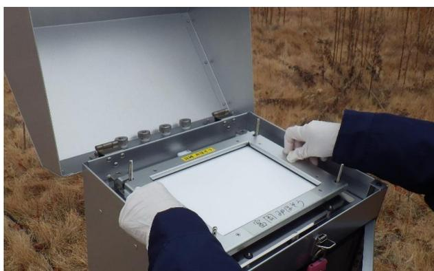
図 2-4 ろ紙の交換作業状況
