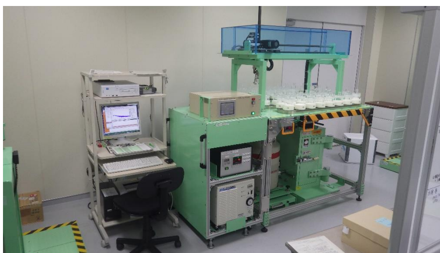
図 2-8 ゲルマニウム半導体検出器を用いた放射能測定作業
