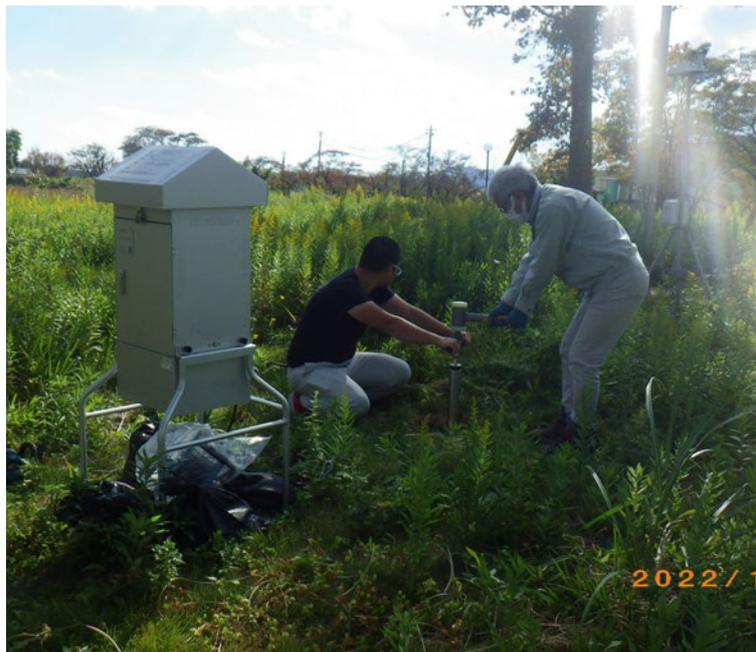
図 2.1-7 コアサンプラー用いた土壌試料採取風景
