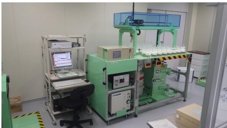
図 2.1-5 ゲルマニウム半導体検出器を用いた放射能測定作業
