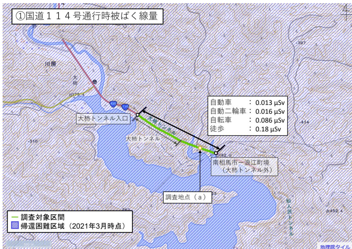
図1 国道114号の空間線量率調査区間及び道路脇調査地点(a)の位置並びに帰還困難区域を1回通行する場合の運転手等の被ばく線量
