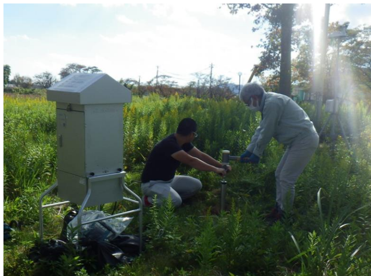
図 2.1-6 コアサンプラー用いた土壌試料採取風景
