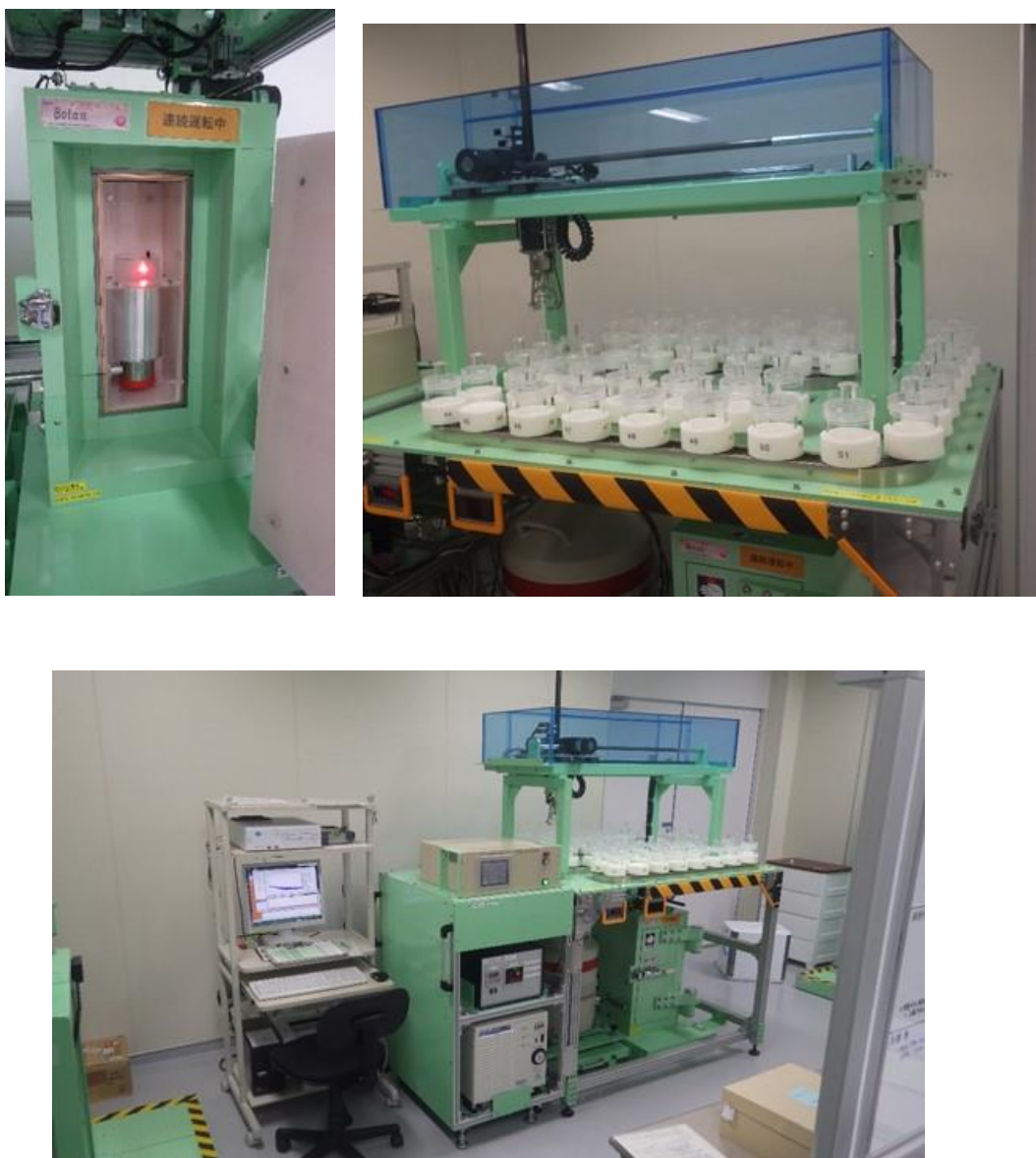
図 2.1-4 ゲルマニウム半導体検出器を用いた放射能測定作業
