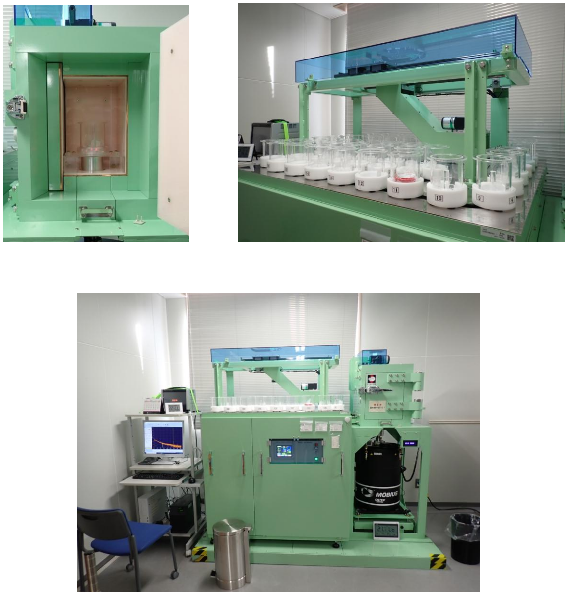
図 2.1-4 ゲルマニウム半導体検出器を用いた放射能測定作業
