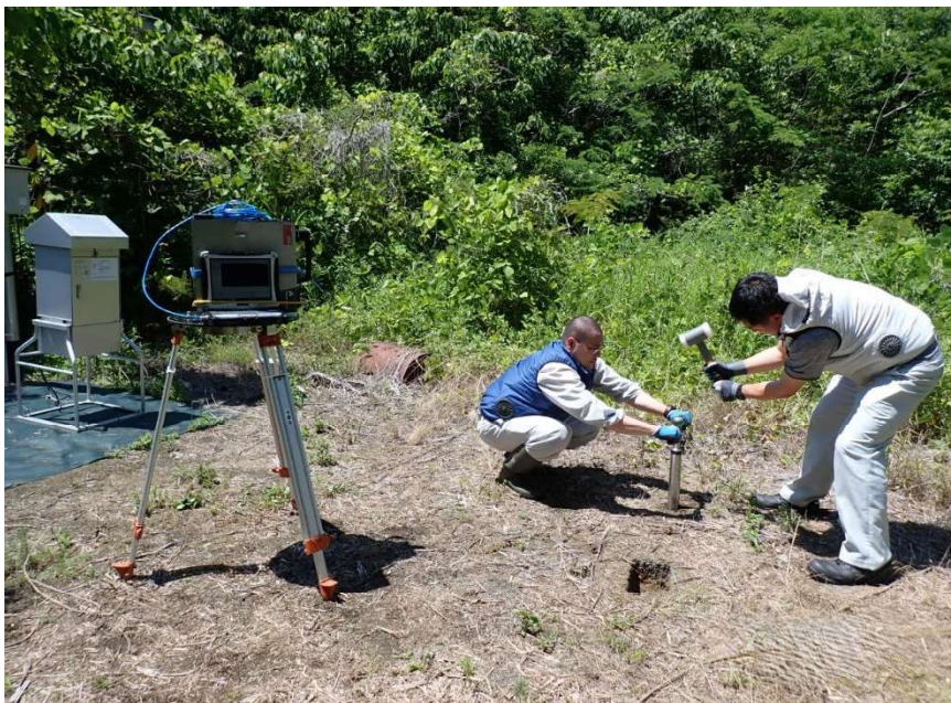
図 2-6 コアサンプラー用いた土壌試料採取風景
