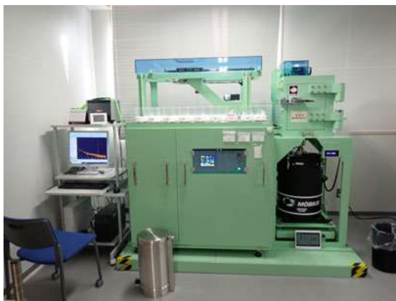
図 2-4 ゲルマニウム半導体検出器を用いた放射能測定作業
