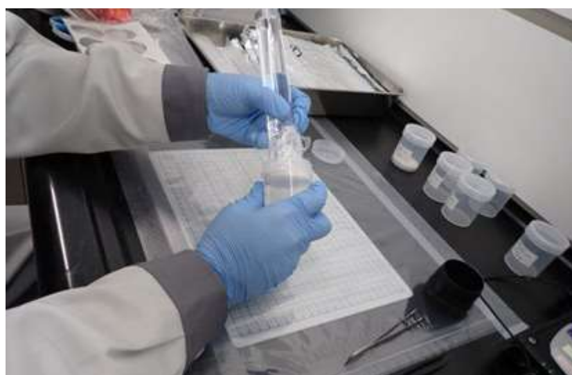
図 2-3 採取試料の放射能測定容器への封入作業
