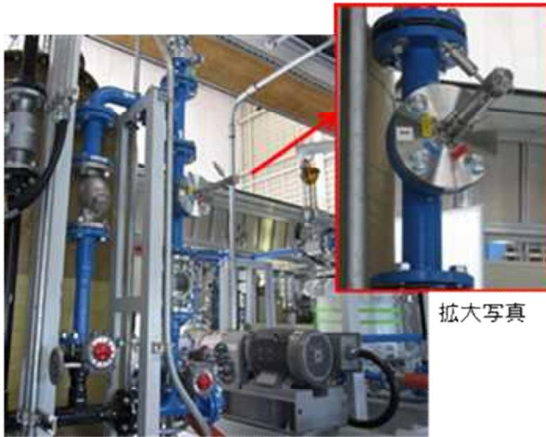
検証装置に組込んだ腐食試験装置(試験箇所①)
