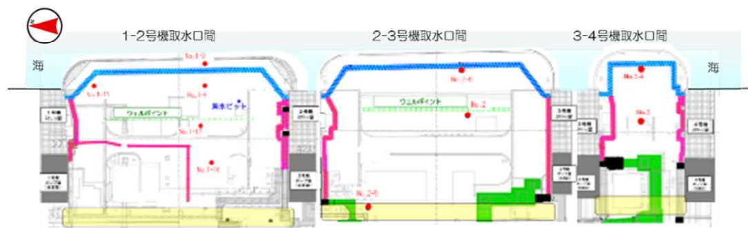
水ガラスによる地盤改良施工箇所
