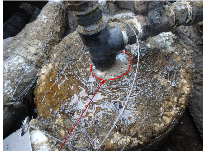
加圧試験時のブライン漏洩状況 1870-6T
