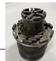
写真1 2段ビット（ \phi 100 ）
