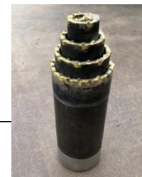
写真2 4段ビット（ \phi 100 ）
