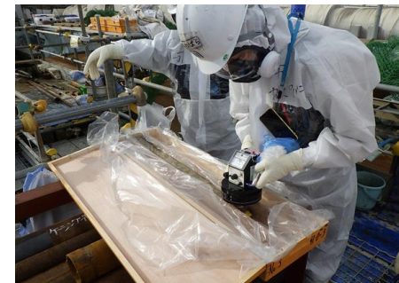
写真2 ボーリングコア表面線量測定状況 ※線量の低い2.5m盤で実施
