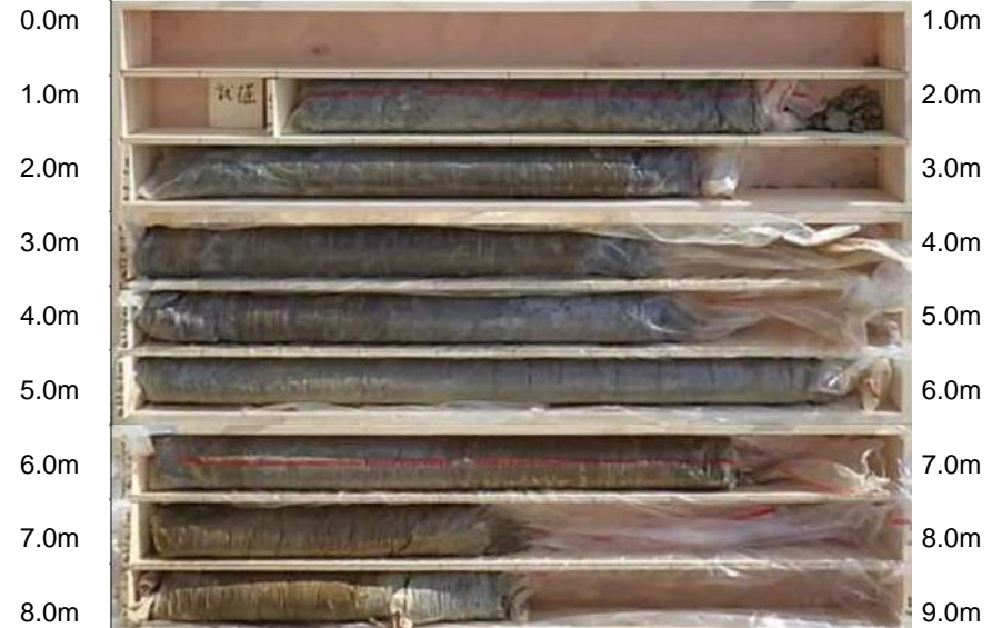
No.25-3-5 ボーリングコア
