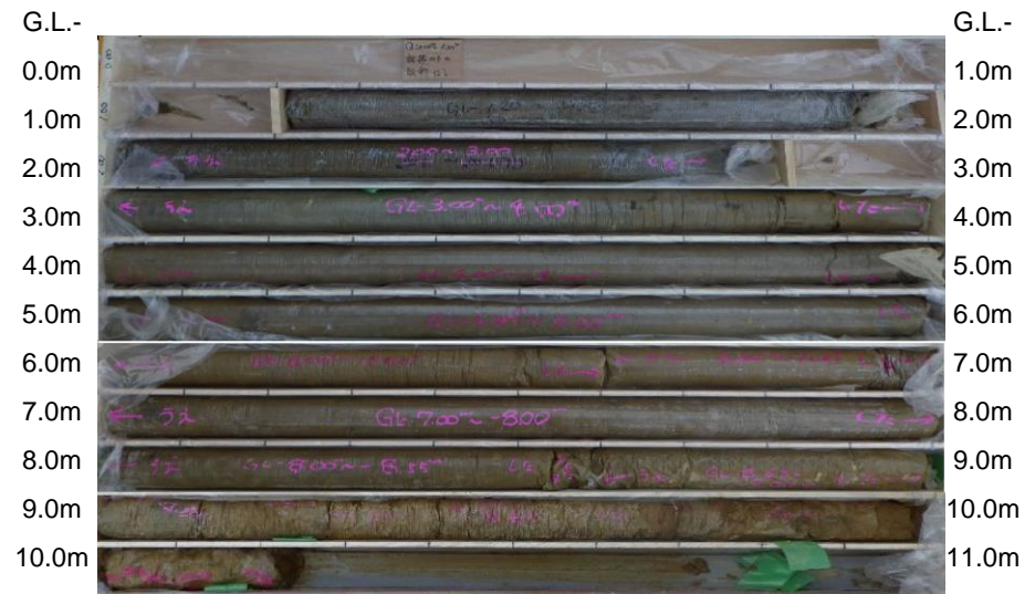
No.25-4-1 ボーリングコア
