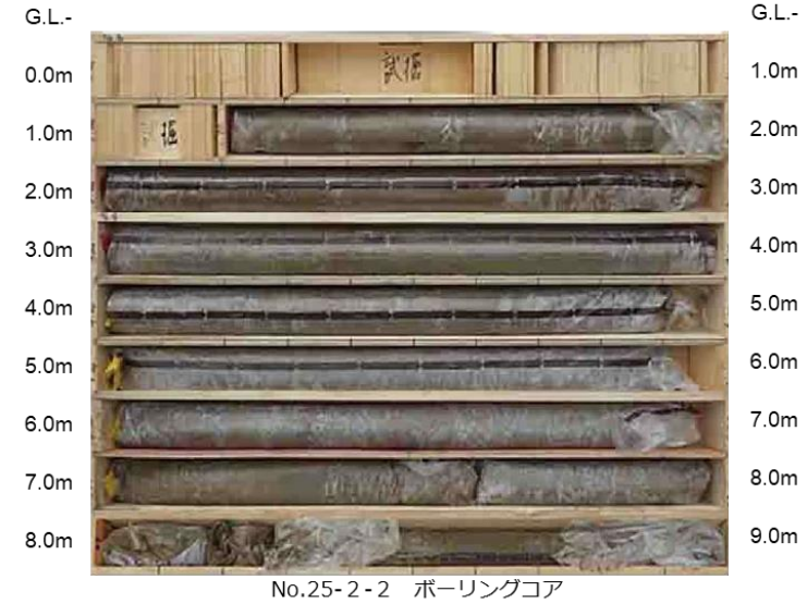
No.25-2-2 ボーリングコア
