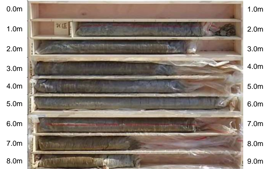
No.24-2-2 ボーリングコア
