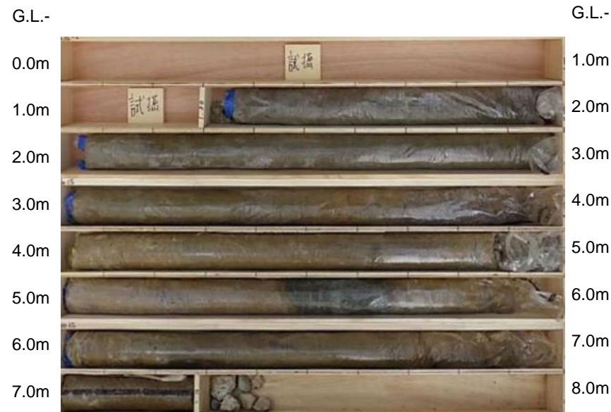
No.25-3-3 ボーリングコア
