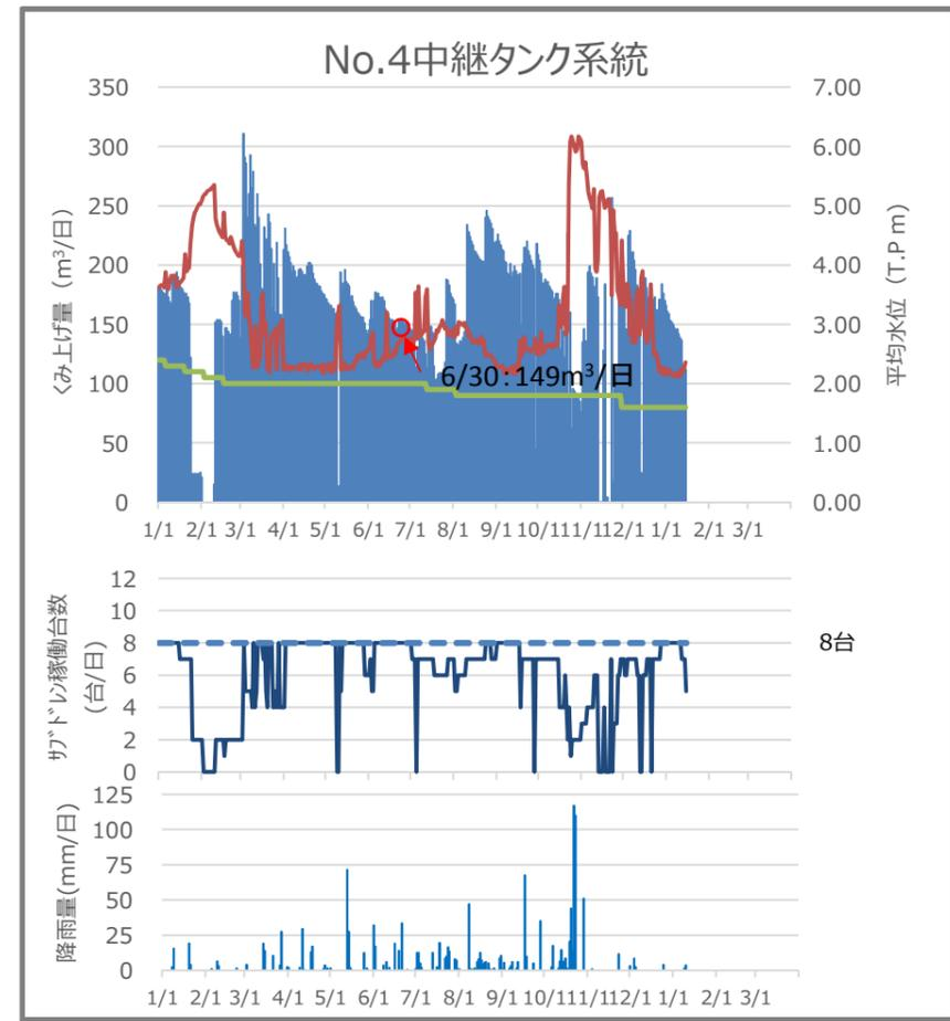
系統毎のサブドレンくみ上げ量の経時変化 (平成29年11月1日～平成30年1月15日)
