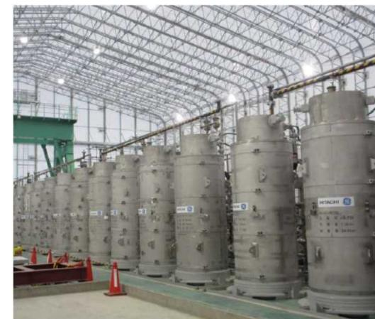
高性能多核種除去設備 吸着塔
