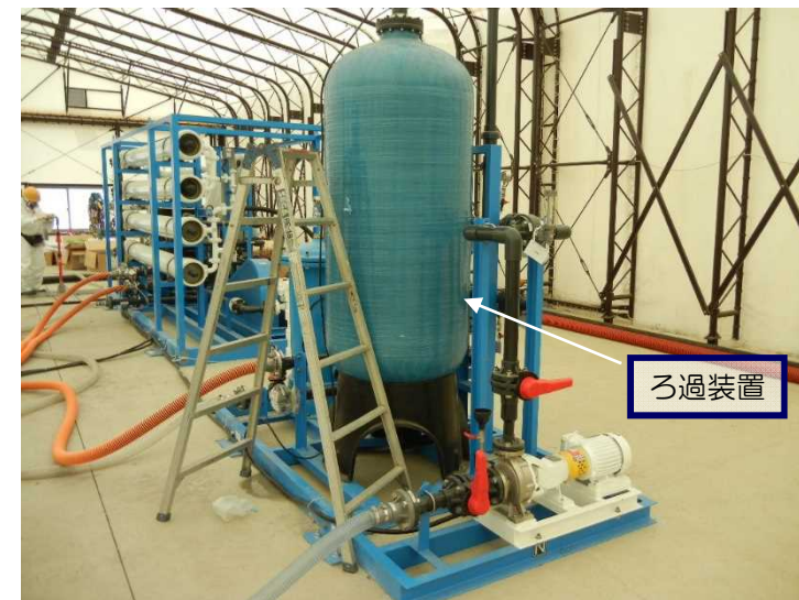
<淡水化装置（ろ過装置）>
