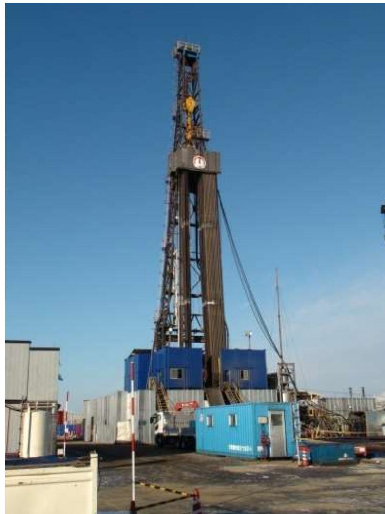
リグ(掘削機械) 高さ: 48.50m
