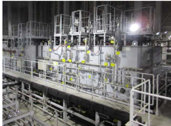
増設多核種除去設備 吸着塔
