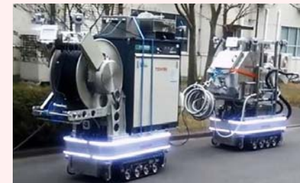
ドライアイスブラスト除染装置
