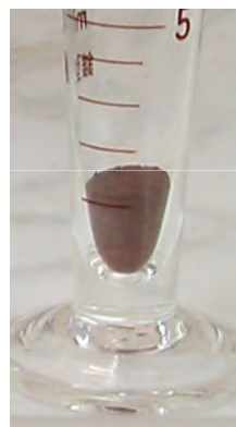
熱分解により減容された模擬スラッジ
