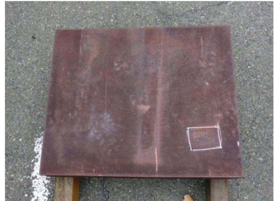
RPV母材供試材(T2)の外観(例)
