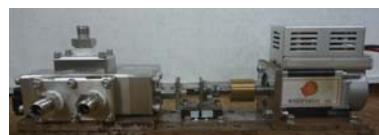
図2 水圧サーボ弁
