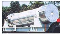
使用済燃料プールから取り出した燃料を共用プールへ移送するため、輸送容器・収納缶等を設計・製造
