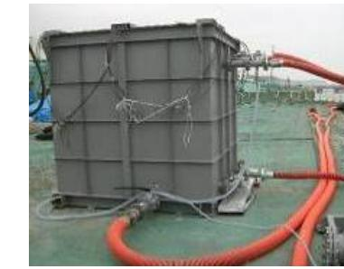
図3：海水循環型浄化装置運転状況
