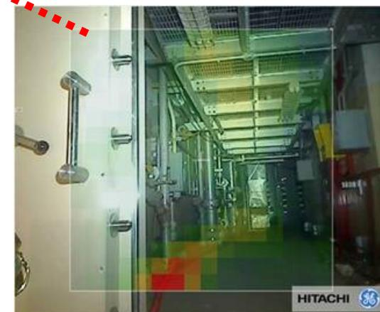
1号機原子炉建屋内線源／線量率
