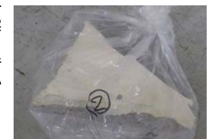
図4. 採取試料の例(コンクリート)
