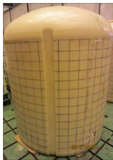
補強リング取り外し後
