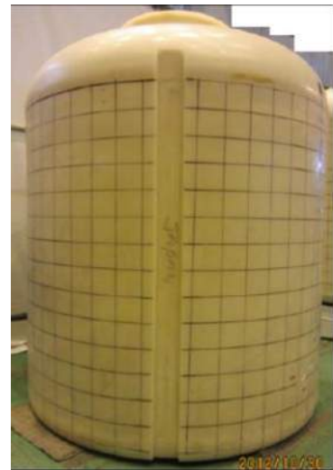
補強リング取り外し後
