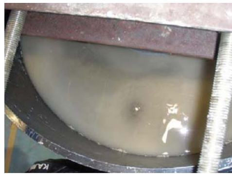
〔打設開始160 分後〕 水みちがダウンカマ界面以外にも発生
