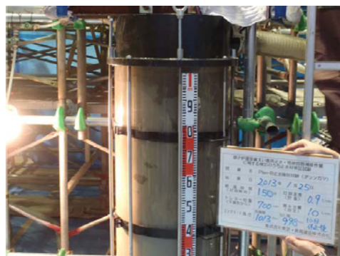
〔打設開始150 分+10 分休止〕 水面から水みちが目視できる
