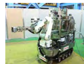
ドライアイスブラスト 除染装置
