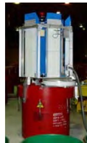
INSEPにより開発が進められている核物質量測定装置(チェルノブイリ)
