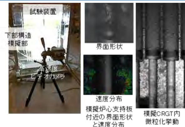
図1 BWR下部構造を模擬した模擬溶融燃料の落下試験
