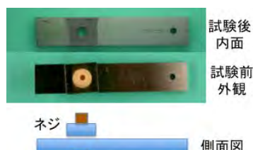
未照射材料を用いたガンマ 線照射下すきま腐食試験
