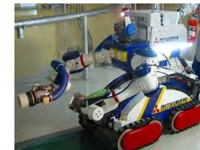
ブラスト・吸引回収 除染装置
