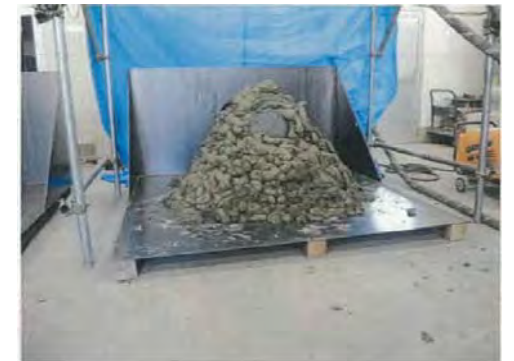
試験結果の例(低スランプモルタル)
