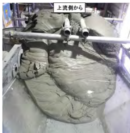
ベント管部止水材要素試験結果(例)
