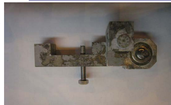
リミットスイッチ検出レバー (腐食後)
