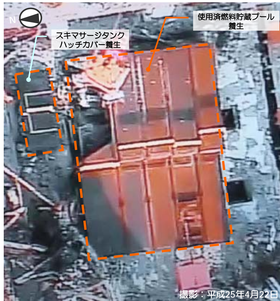
使用済燃料貯蔵プール養生（第一段階）および スキマサージタンクハッチカバー養生の設置完了
