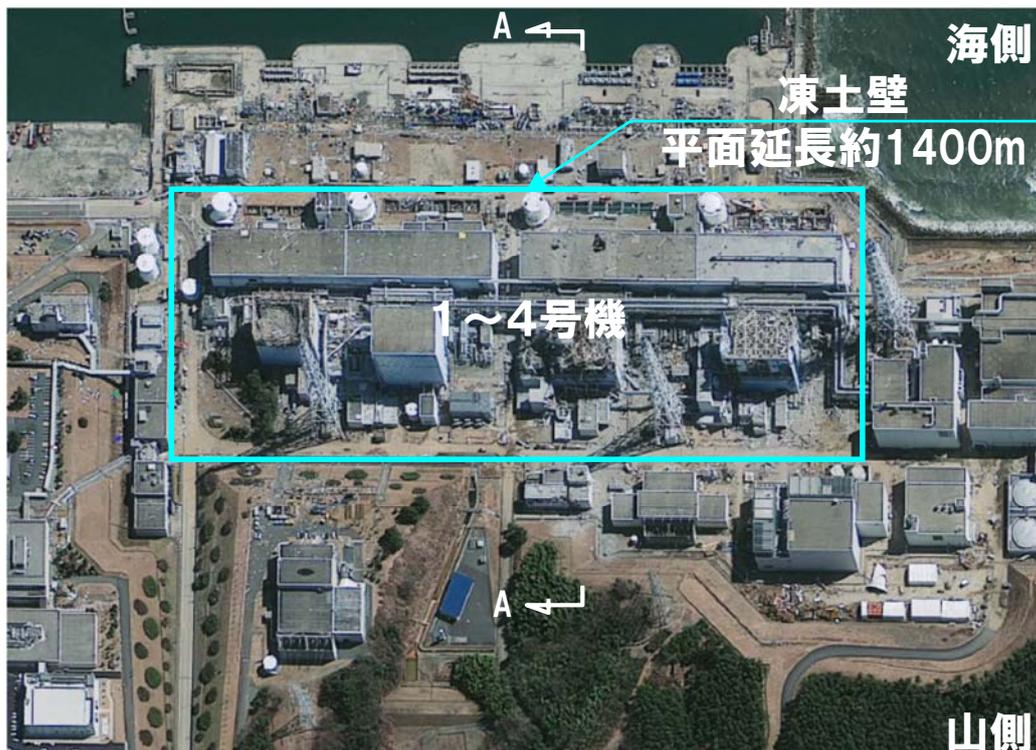
凍土壁は施工可能な**最小規模**で閉合
