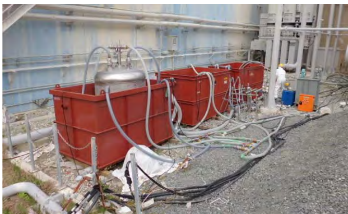
サブドレンピット浄化試験で用いた設備の例
