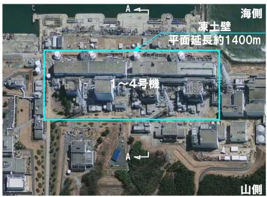
凍土壁は施工可能な<mark>最小規模</mark>で閉合 3
