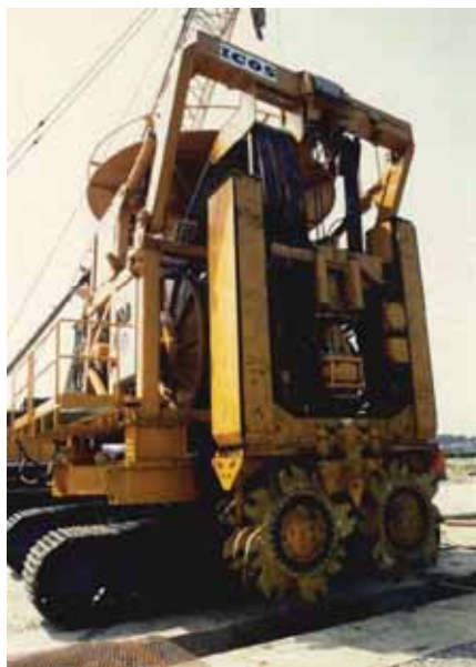
連壁部の施工機械
