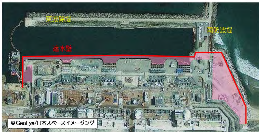
〔海側遮水壁の配置図(出典:東京電力)〕
