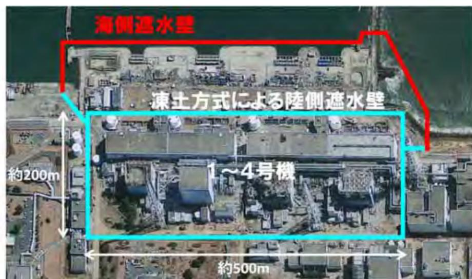
[凍土による陸側遮水壁の配置イメージ (図の上方が東側)]
