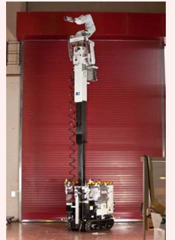
高所調査用ロボット※外観 ※（独）産業技術総合研究所と（株）本田技術研究所が共同開発した『高所調査用ロボットシステム』を東京電力（株）も含まれた三社共同研究の中で運用。
