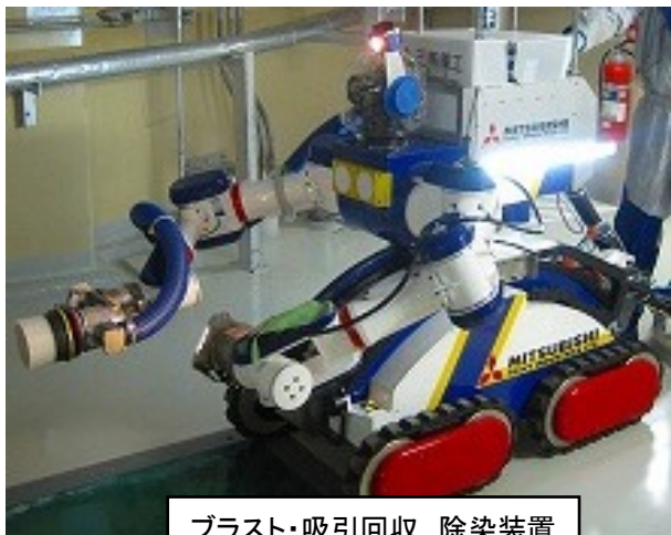
ブラスト・吸引回収 除染装置
