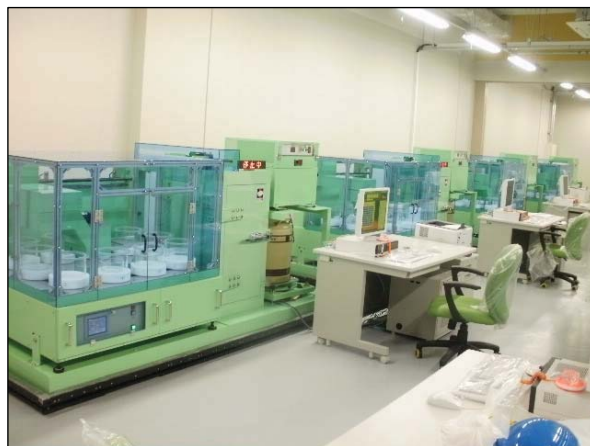
新分析室（地下1階）における Ge半導体検出器の配備状況
