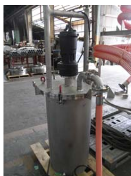
吸引回収装置 (小片ガレキ回収用)
